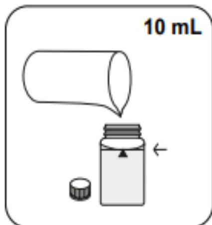
Remplissez une cuvette de 24 mm de **10 mL d'échantillon**.
