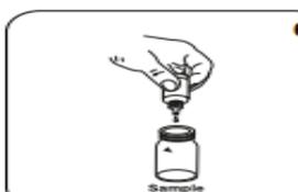
Ajoutez **6 gouttes de DPD 1 Buffer Solution** dans la cuvette réservée à l'échantillon.
