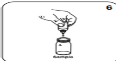
Ajoutez **6 gouttes de DPD 1 Buffer Solution** dans la cuvette réservée à l'échantillon.
