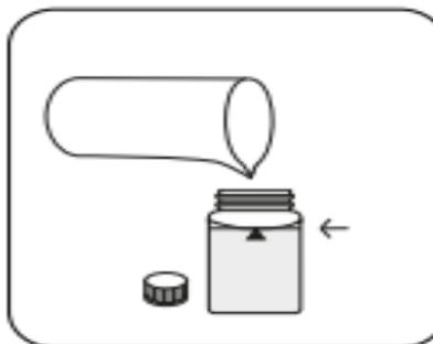
Remplissez la cuvette jusqu'au repère de **10 mL** en y versant l'échantillon.
