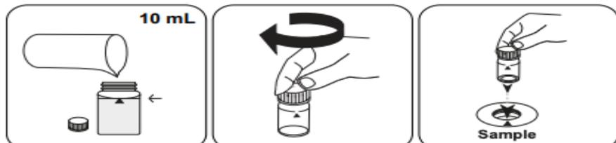
Remplissez une cuvette de 24 mm de 10 mL d'échantillon.
