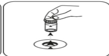
Retirez la cuvette de la chambre de mesure.
