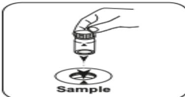
Placez la **cuvette réservée à l'échantillon** dans la chambre de mesure. Attention à la positionner correctement.
