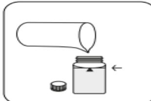
Remplissez la cuvette jusqu'au **repère de 10 mL** en y versant l'échantillon.
